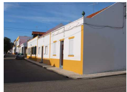
Figura 3 – Largura de Passeios insuficiente
